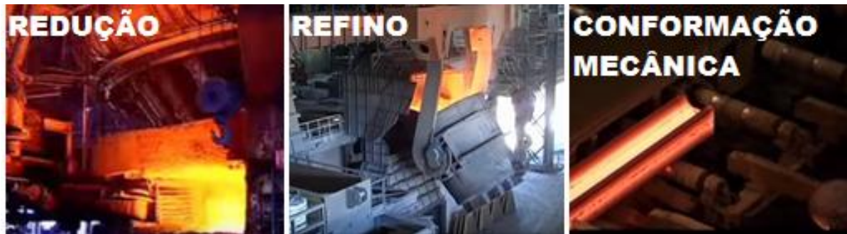
Figura 3 - Processos de usina integrada.
