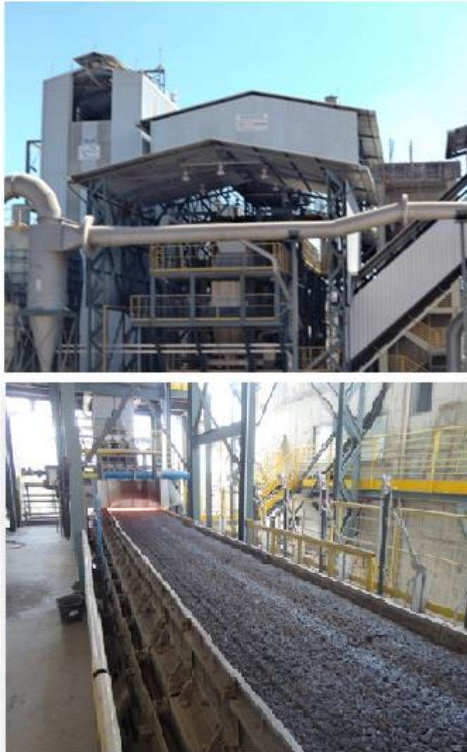
Figura 23 – Sinterização Contínua da Tecnosulfur destinada a sinterização para Aciaria.
