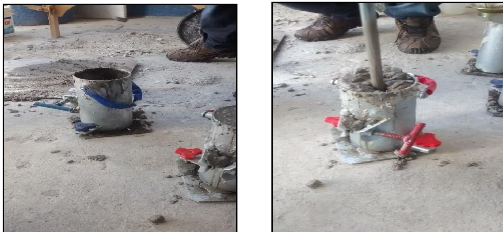
Figura 23- Moldagem de corpos de Prova.
