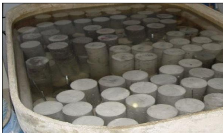
Figura 24 – Cura úmida do corpo de prova.
