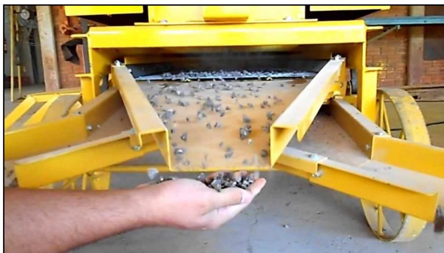
Figura 20 Peneiramento em Malha de 4,8 a 19 mm
