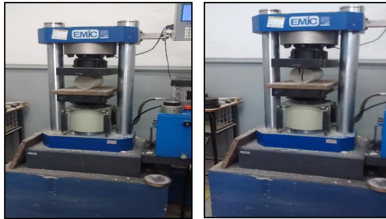
Figura 26 – Ensaio de Resistência à Tração.
