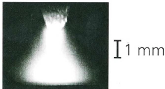
Figura 28: Arco voltaico entre eletrodo tungstênio e bloco de cobre atmosfera de argônio.
