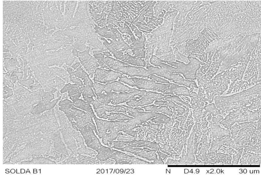
Figura 63: MEV na amostra b1Xb2 (aço carbono e ferro fundido cinzento); ZTA 2000x.
