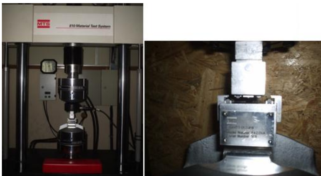
Figura 9: Máquina Universal de Ensaios com adaptador para Fadiga a Flexão – USP-EEL-Demar. À direita fotografia do Kit para ensaios de flexão/fadiga.
