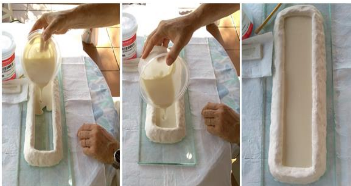
Figura 42 – Preparação dos moldes dos corpos de prova.
