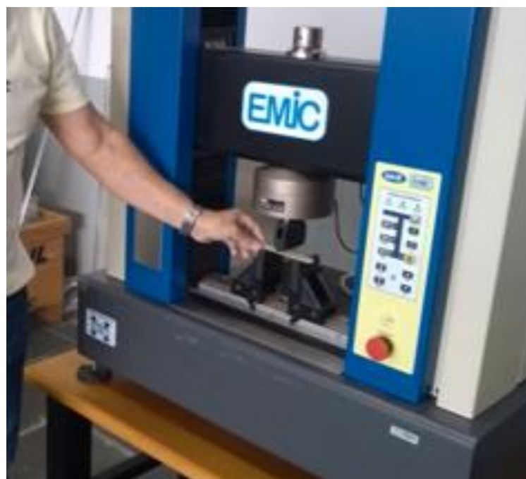
Figura 76 – Posicionamento do corpo de prova para o ensaio de flexão.
