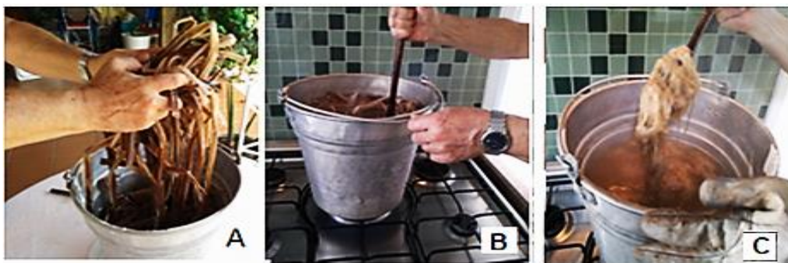
Figura 33 – Bainhas imersas no caldeirão, B- Cozimento com H 2 O, C- Separação.
