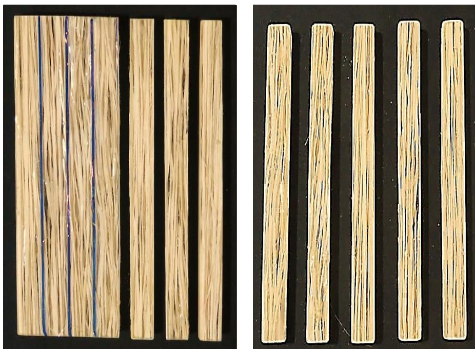
Figura 69 – Corte da placa no formato dos CPs para ensaio de flexão.
