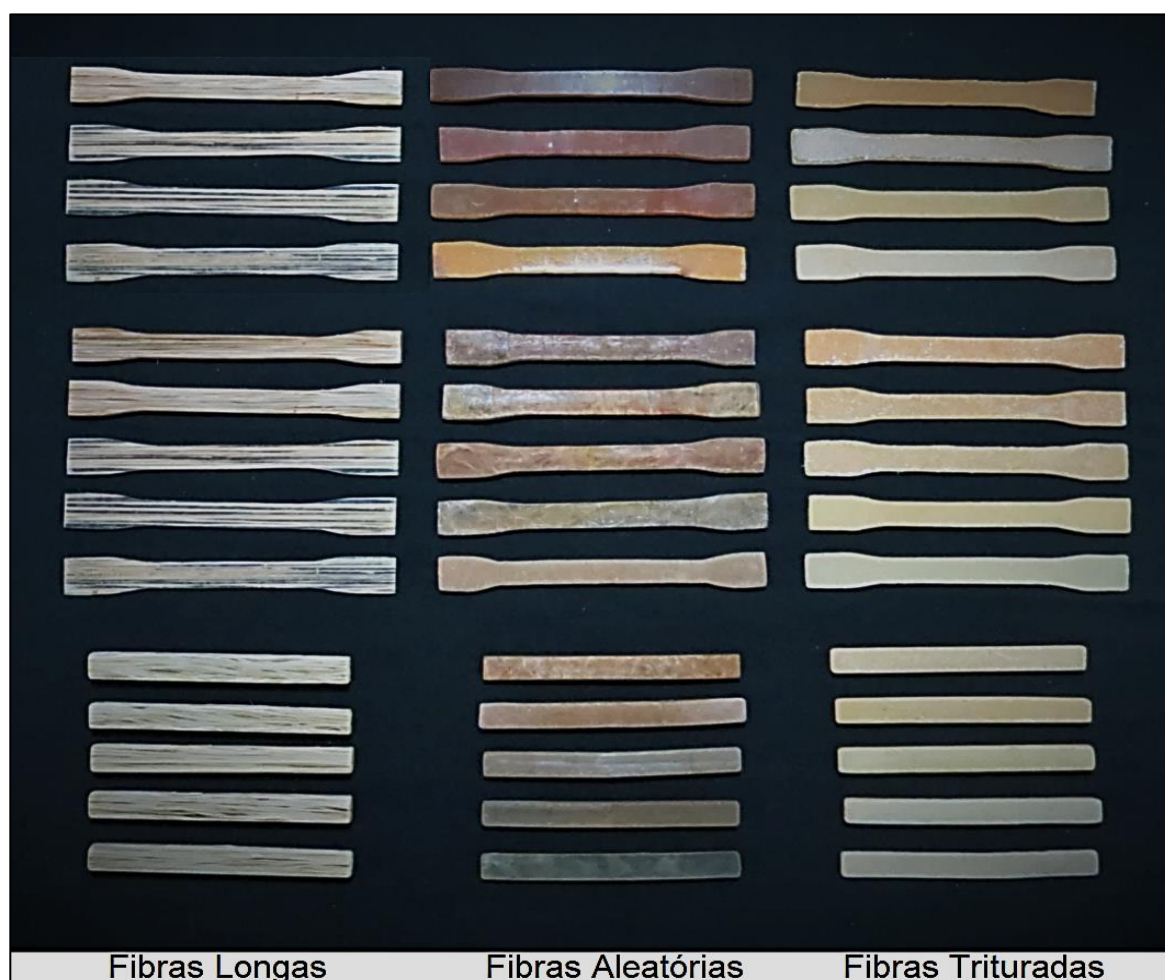
Figura 71 – Corpos de prova com os três tipos de fibra, prontos para os ensaios.
