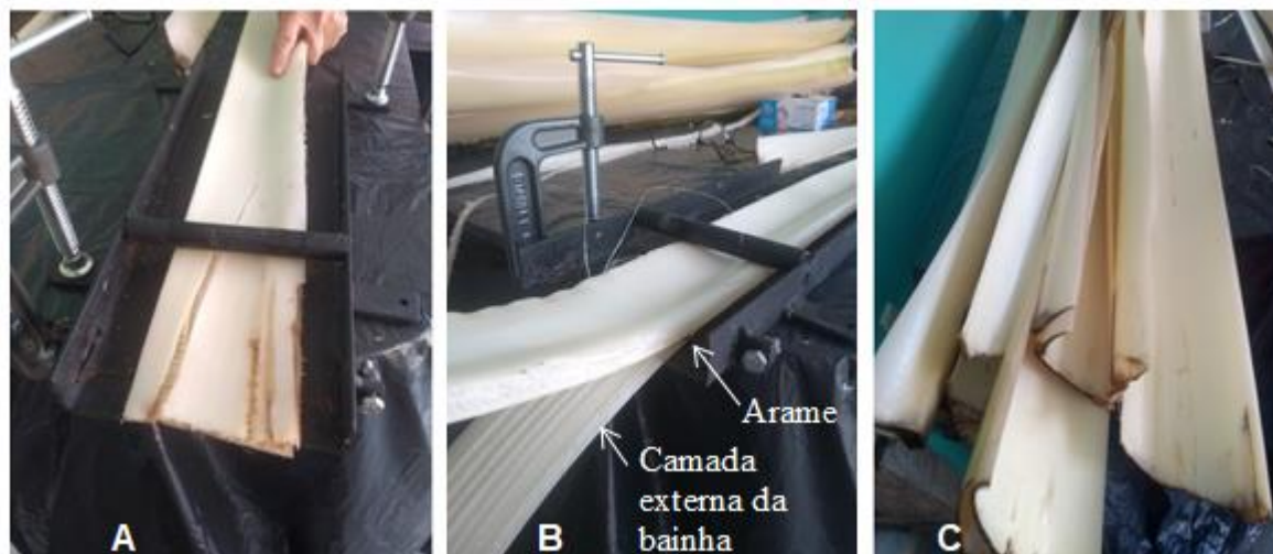
Figura 63 – Obtenção das fibras longas: A: Bainhas dispostas sobre a mesa para a extração das camadas; B: Desdobramento das bainhas foliares; C: Região interna extraída das bainha foliares.
