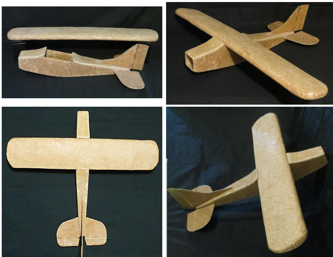
Figura 123 – Conclusão do revestimento da asa e do corpo do aeromodelo.
