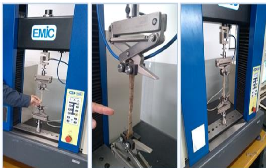
Figura 74 – Imagens de um ensaio de tração até o rompimento do CP.
