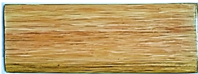
Figura 117 – Compósito com fibras de bananeira longas unilaterais e resina epóxi.
