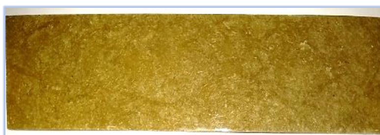
Figura 115 – Protótipo com compósito com manta de fibra aleatória de bananeira.
