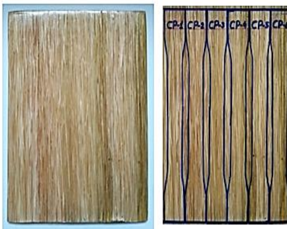
Figura 67 – Placa do compósito marcada para corte no formato dos CPs.
