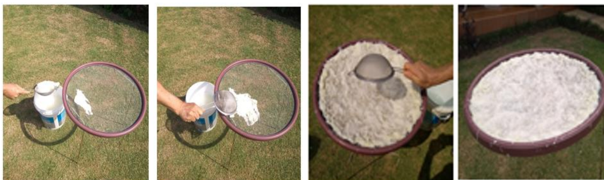
Figura 38 – Moldagem da manta de fibra sobre a peneira.
