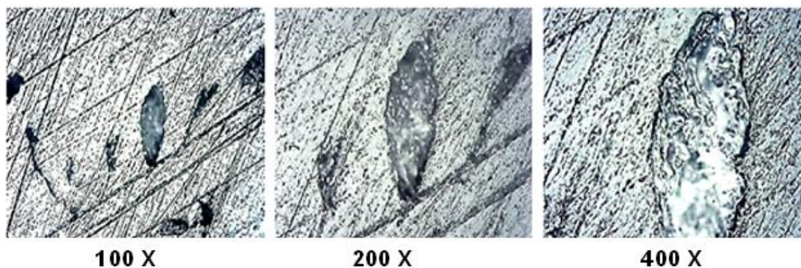
Figura 106 – Corte transversal, fibras trituradas; I- Ampliação de 100 vezes; II- Ampliação de 200 vezes e III- Ampliação de 400 vezes.
