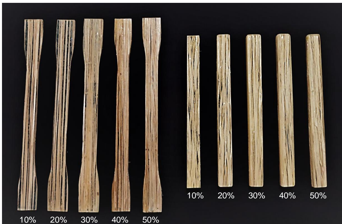
Figura 70 – Corpos de prova do compósito de resina epóxi com fibras longas.
