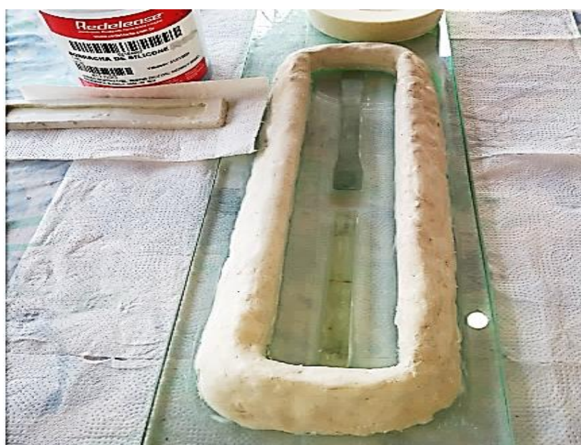
Figura 41 – Forma para a preparação dos moldes.
