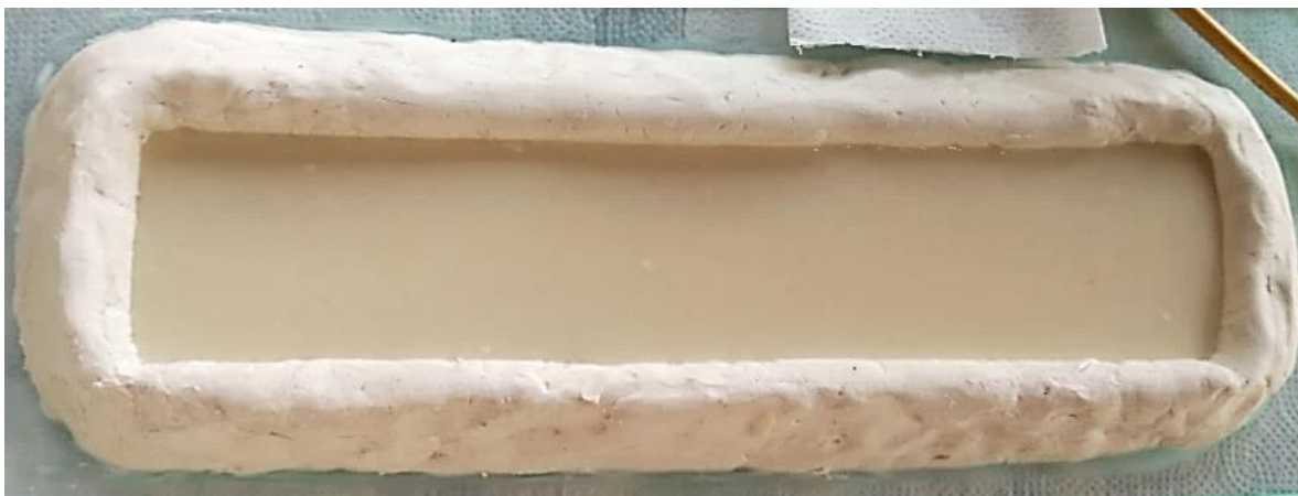
Figura 43 – Molde de borracha de silicone ainda na fase líquida.
