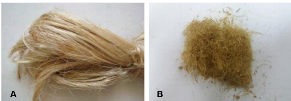
Figura 6 – A: Fibras longas de bananeira após secagem, B: Fibras de bananeira trituradas.
