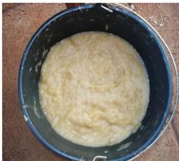
Figura 35 – Massa de fibra pronta para ser clareada.
