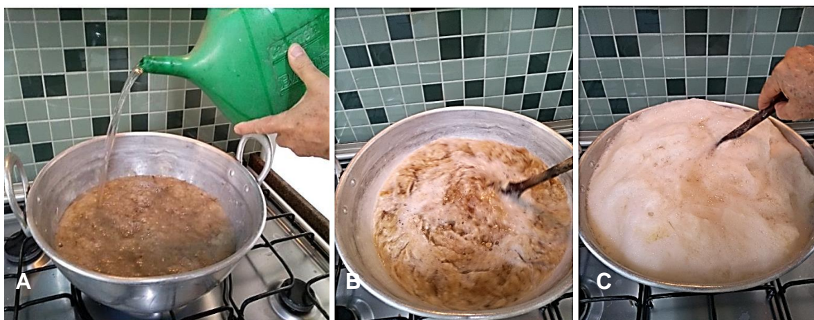
Figura 34 – A- Adição água filtrada, B- Agitação com NaOH, C- Fervura da mistura.
