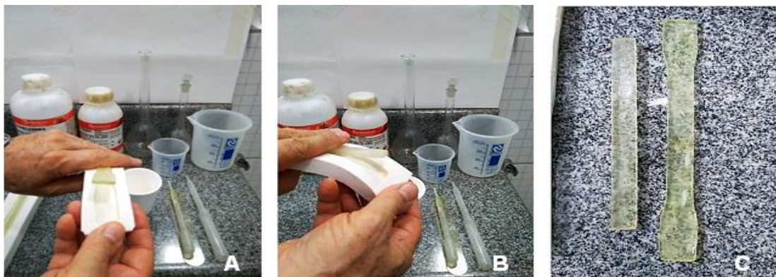
Figura 47 – A- Desmoldando os CPs de flexão, B- Desmoldando os CPs de tração, C- CP's de flexão e tração prontos para os ensaios.
