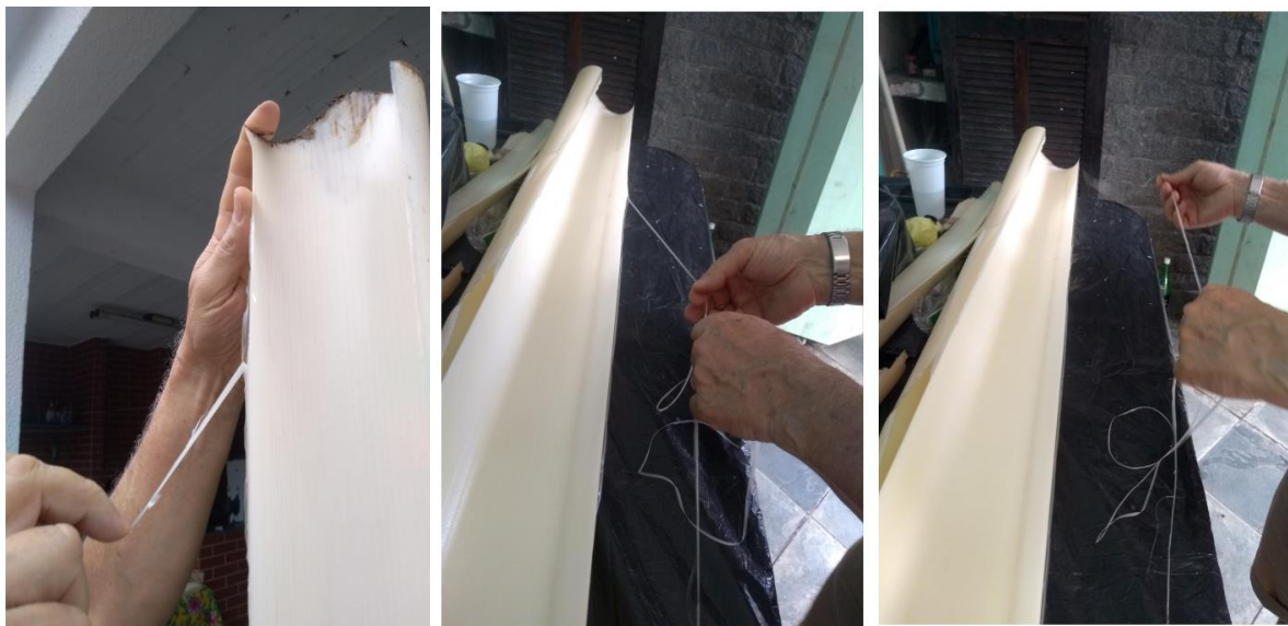
Figura 64 – Extração da fibras longas longitudinais.
