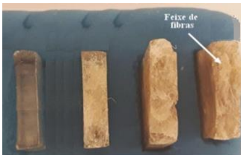
Figura 83 – Amostras de resina epóxi pura, resina epóxi com fibras aleatórias, trituradas e longas.
