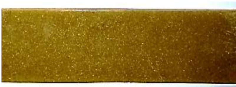
Figura 116 – Compósito com fibra de bananeira triturada e resina epóxi.
