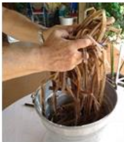
Figura 32 – Bainhas imersas em solução de água destilada e ácido acético.
