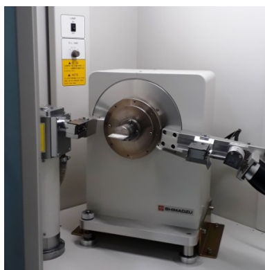
Figura 15. Amostra no difratômetro.
