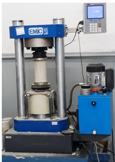
Figura 13. Ensaio de resistência à compressão axial
