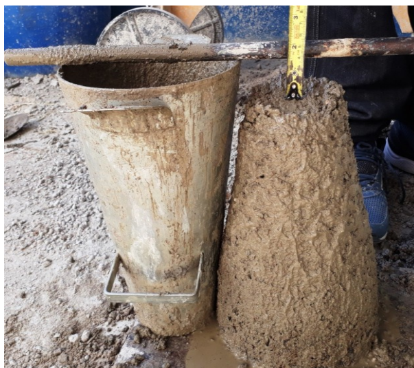
Figura 11. Teste Slump para aferição da fluidez.
