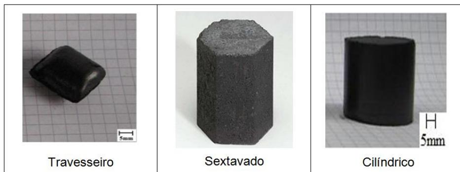
Para uso geral um briquete possui diâmetro entre 30 -70 mm (média um diâmetro a partir de 50 mm). Pode alcançar diâmetros até 120-130 mm nos equipamentos industriais. Comprimento pode variar de 15 a 400 mm, sendo que em média é de 50-100 mm.
