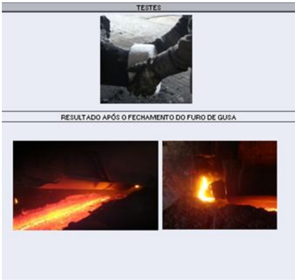
Figura 32 – Teste de campo com amostra 5 proteção cerâmica \text{SiO}_2(62-68)\text{-MgO+CaO}(29-39)
