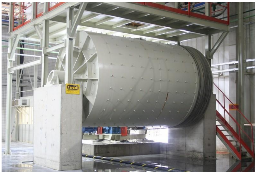
Figura 2 – Moinho de bolas para moagem de argilas tipo Cardall. [16]
