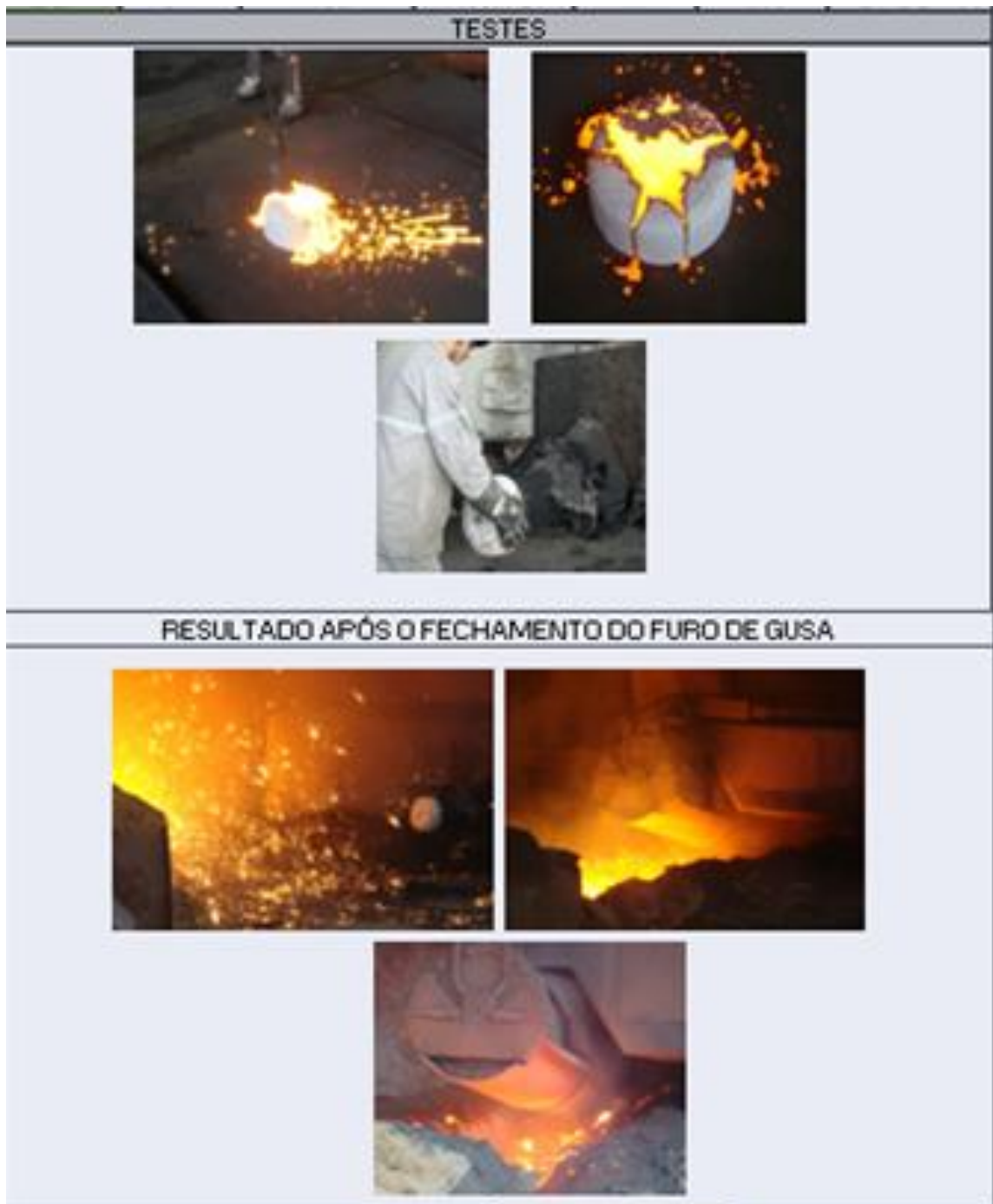
Figura 30 – Teste de campo com amostra 3 proteção cerâmica \text{SiO}_2(62-68)\text{-MgO+CaO}(29-39)
