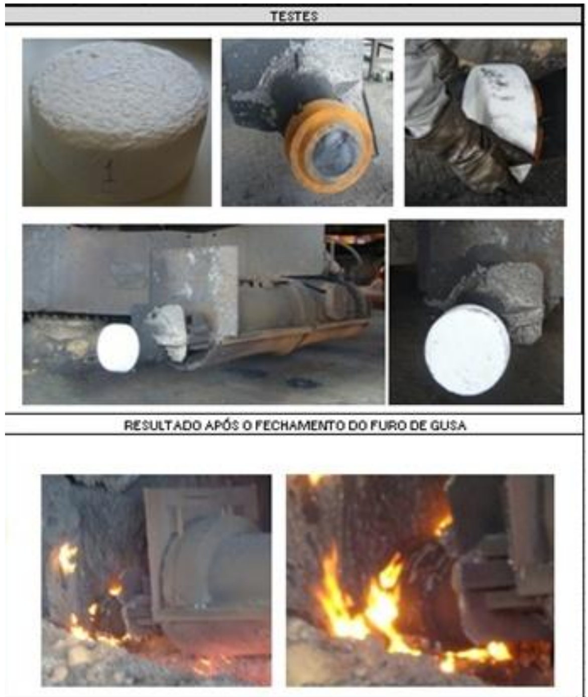
Figura 28 – Teste de campo com amostra 1 proteção cerâmica \text{SiO}_2(62-68)\text{-MgO+CaO}(29-39) .
