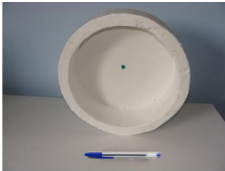
Figura 17 – Amostra proteção cerâmica \text{SiO}_2(62-68)\text{-MgO+CaO}(29-39) .
