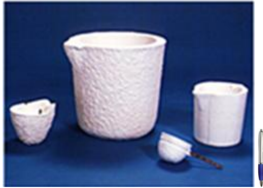
Figura 5 – Manta em formato especial á vácuo, citado em relatório técnico da Morganite do Brasil [33]
