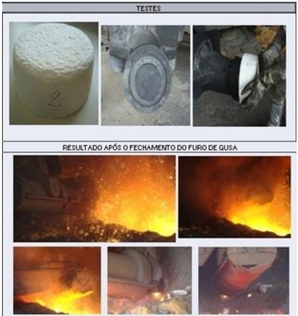
Figura 29 – Teste de campo com amostra 2 proteção cerâmica \text{SiO}_2(62-68)\text{-MgO+CaO}(29-39) .
