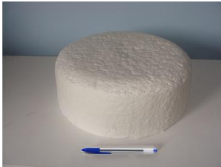
Figura 16 – Amostra proteção cerâmica \text{SiO}_2(62-68)\text{-MgO+CaO}(29-39) .
