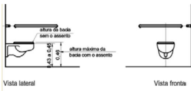
Figura 7 - Medidas de posicionamento e representação da bacia sanitária suspensa
