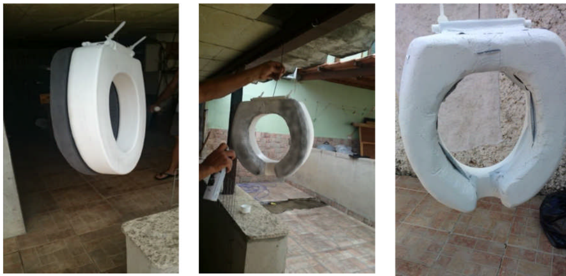
Figura 36 - Pendurando, aplicando o spray e envelopamento total
