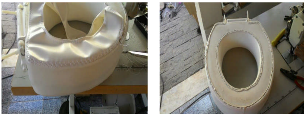
Figura 39 - Fixação do courvin por grampos e costura
