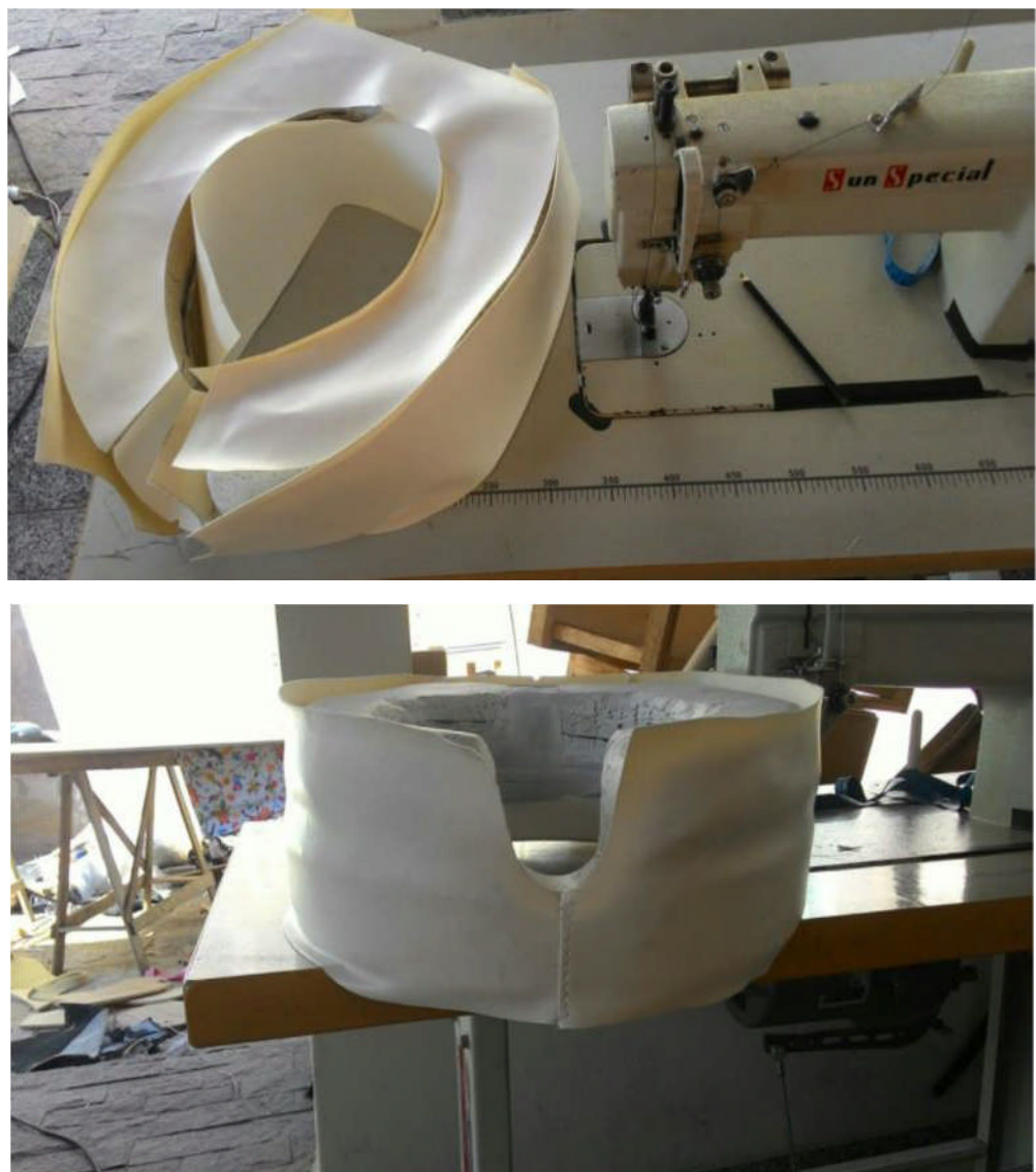
Figura 38 - Recorte do courvin e início da dobra e costura do material
