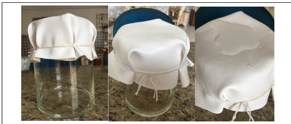
Figura 41 – Teste de impermeabilidade do courvin
