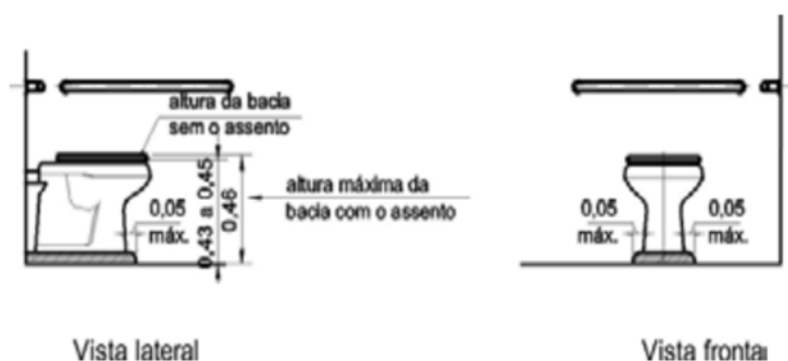
Figura 9 - Medidas de posicionamento e representação da bacia sanitária com coluna com sóculo adaptado
