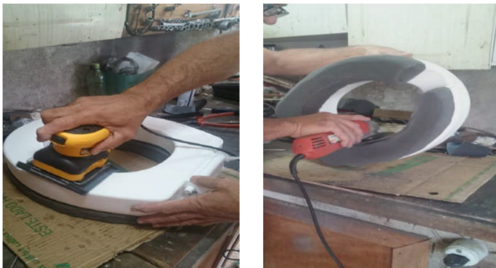
Figura 35 - Lixando a base e modelando a espuma
