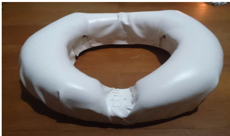
Figura 33 - Processo de encapamento do assento do assento sanitário (estágio inicial).
