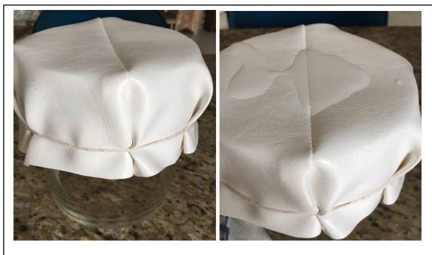
Figura 42 – Teste de impermeabilidade no local da costura
