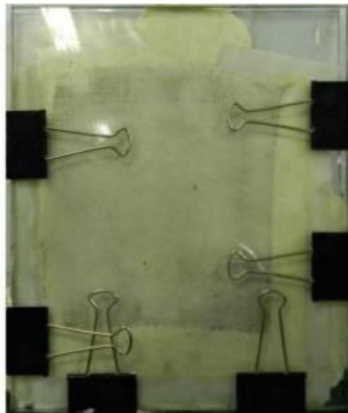
Figura 3.2. Processo de moldagem por compressão utilizado para obtenção do compósito.
