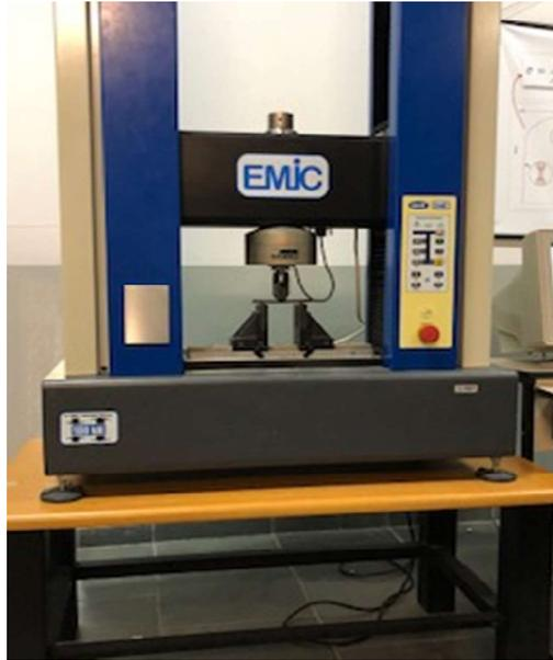
Figura 14- Ensaios de flexão no equipamento EMIC DL-10000. Fonte: a autora
