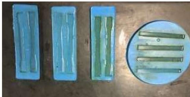
*Figura 11- Confeção de corpos de prova com resina Epóxi Pura. Fonte: a autora (2021)*
