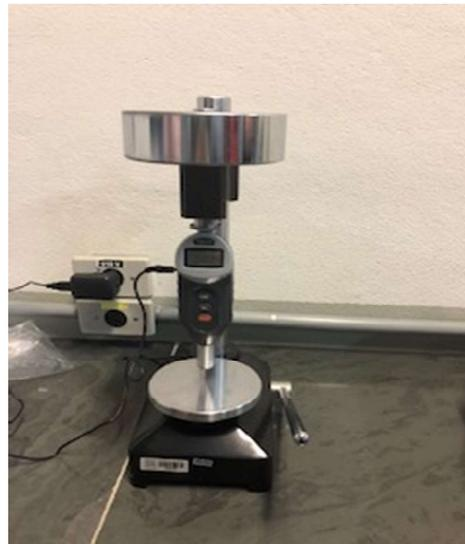
Figura 15- Ensaios de Dureza Shore D. Fonte: a autora
