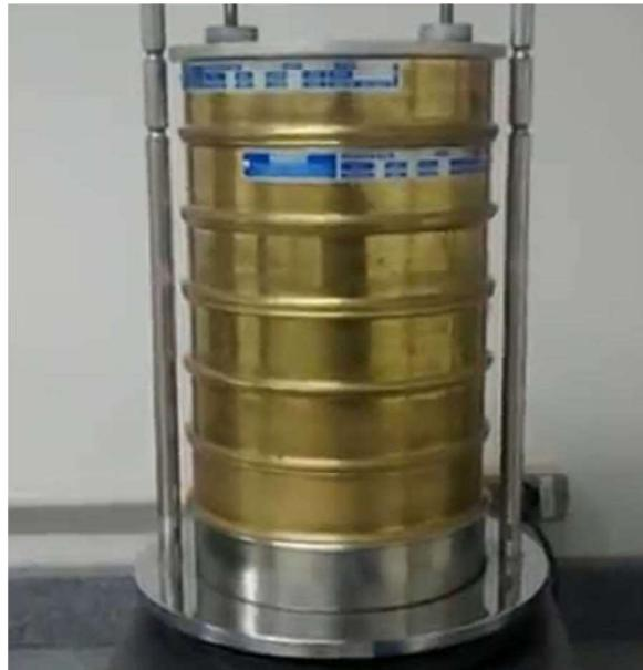
Figura 10- Máquina de separação granulométrica. Fonte: a autora
