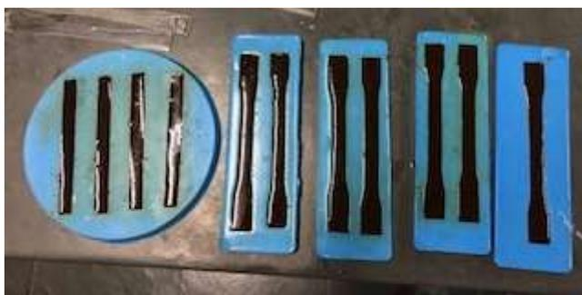
*Figura 12- Confeção de corpos de prova com resina Epóxi Fino à 10%. Fonte: a autora (2021)*
