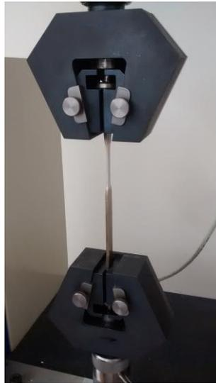
Para cada compósito avaliado, foram ensaiados cinco corpos de prova com dimensões de acordo com a norma ASTM D 638 – 03 com 13 mm de largura, 165 mm de comprimento e 3 mm de espessura.
