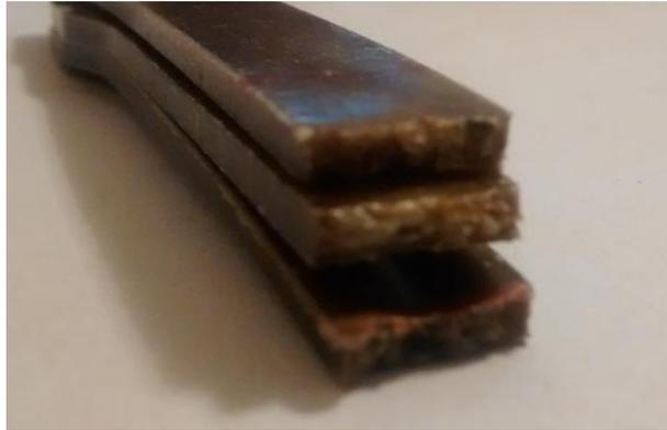
O estudo da fratura através do MEV revela áreas nas quais ocorreram algumas das possíveis falhas. As superfícies da fratura dos compósitos podem ser visualizadas nas Figuras 27 a 32, as quais mostram que os compósitos apresentaram fluxo da matriz, ou seja, deformação plástica do polipropileno.
