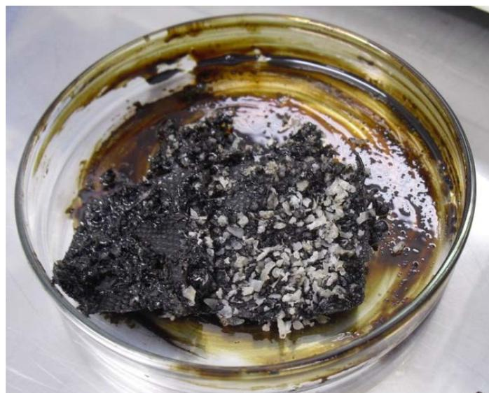
Figura 4.12: Falha de Sorção do Material.
