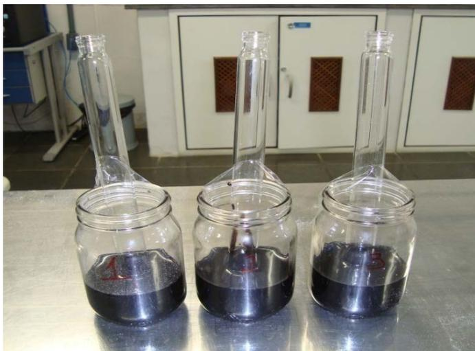
Figura 3.8 Fixação das amostras no recipiente para o ensaio de sorção.
