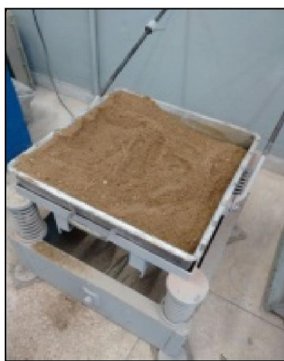
Fotografia 26 - Peneiramento preliminar - remoção de Impurezas da areia
