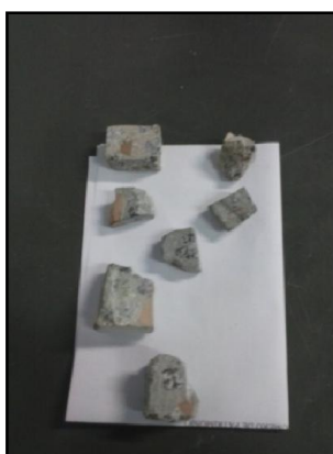
Fotografia 58 - Preparação de pastilhas do compósito
