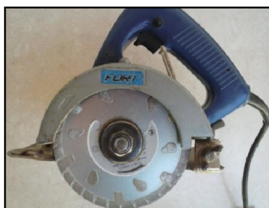
Fotografia 54 - Serra mármore com disco de corte
