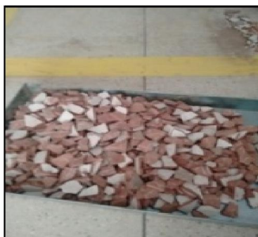
Fotografia 21 - Cerâmica após moagem sem peneiramento
