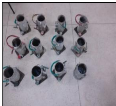
Fotografia 28 – Revestimento dos Moldes com Óleo
