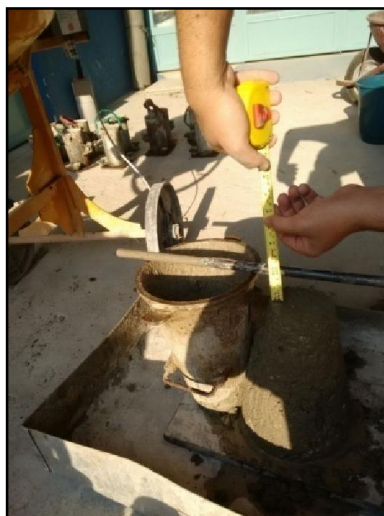
Fotografia 15 - Trena para medição do abatimento
