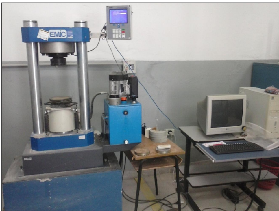
Fotografia 17 - Prensa EMIC T1000 – Capacidade: 100MPa
