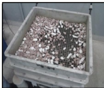
Fotografia 22 - Peneiramento da Cerâmica no granulômetro Manupen
