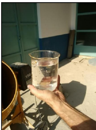
Fotografia 30 - Controle do a/c (adição de Água) com Becker graduado
