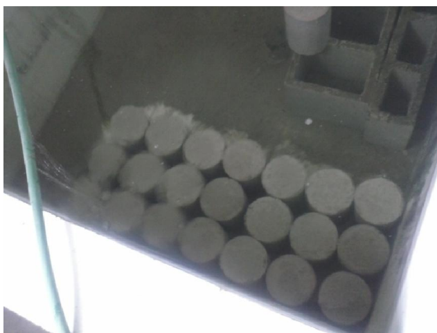
Fotografia 34 - CPs imersos em Tanque d'água, após 24 de Cura
