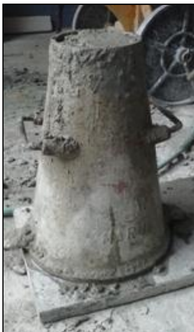
Fotografia 13 - Cone e Prancha de Aço para o Teste de Slump
