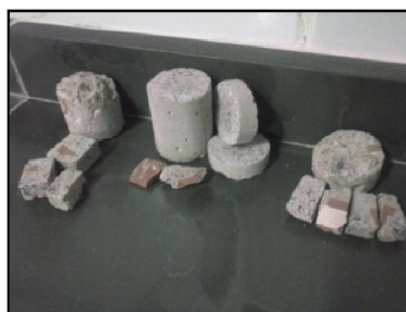
Fotografia 55 - Pastilhas de amostra do compósito para análise MEV
