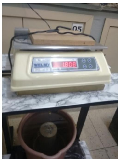
Fotografia 53 - Balança de Precisão alterada para Hidrostática
