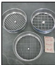
Fotografia 23 - Conferência do Peneiramento (granulometria)
