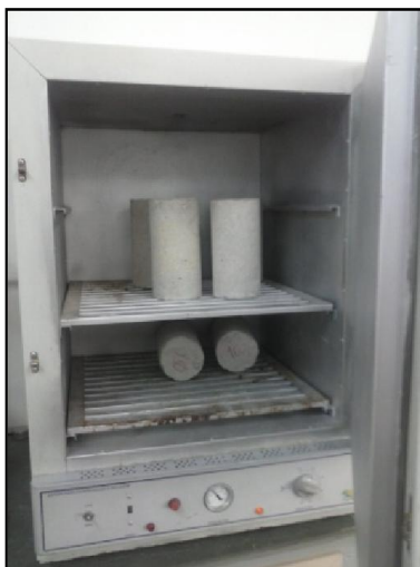
Fotografia 51 - CPs em Estufa para secagem
