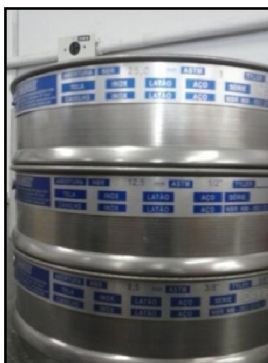
Fotografia 9 - Peneiras marca Soloteste Ø: 9.5mm e 19mm
