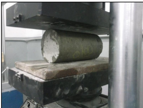
Fotografia 39 - Placas da prensa comprimindo no CP - Ensaio de Tração
