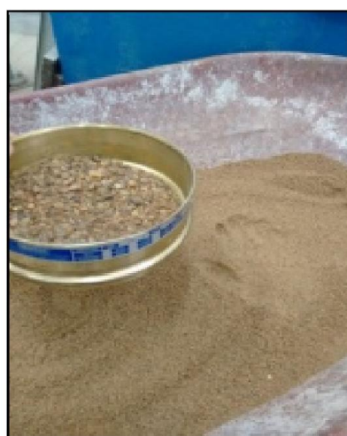
Fotografia 27 - Peneiramento da Areia – Granulometria \text{Ø}2\text{mm}
