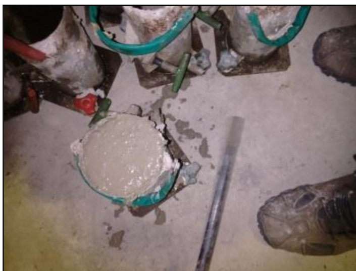
Fotografia 32 - Envasamento e Compactação do Concreto nos Moldes
