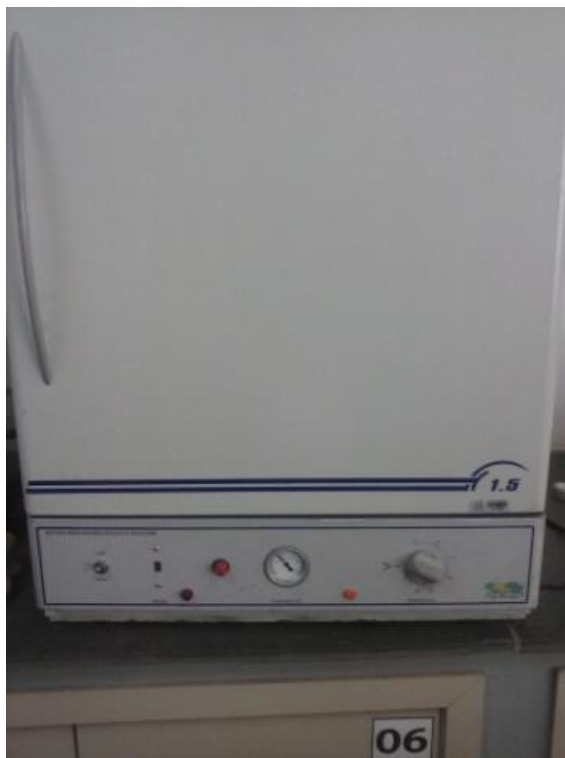
Fotografia 18 - Estufa Odontobrás - Secagem de CPs à 105°C
