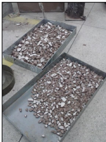
Fotografia 24 - Cerâmica já peneirada ( \varnothing 9,5\text{mm} a \varnothing 19,0\text{mm} )
