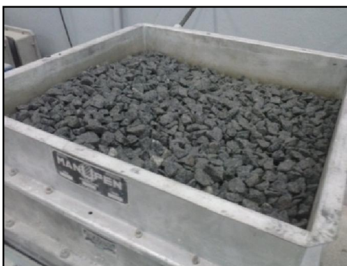
Fotografia 3 - Britas (1 e 2) utilizadas no compósito
