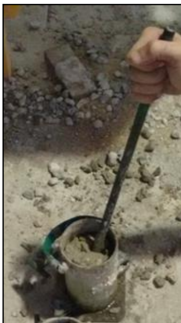
Fotografia 14 - Barra de aço (60cm x Ø1,5cm)
