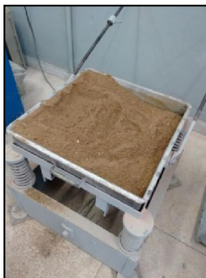
Fotografia 4 - Areia média (granulometria \varnothing 2mm )
