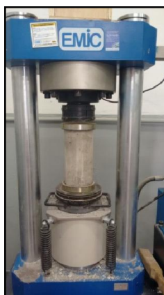
Fotografia 35 - Preparação da Prensa EMIC para Ensaio de Compressão
