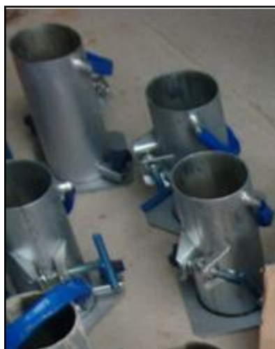
Fotografia 12 - Formas Soloteste - Cilíndricas base Ø10cm x altura 20cm
