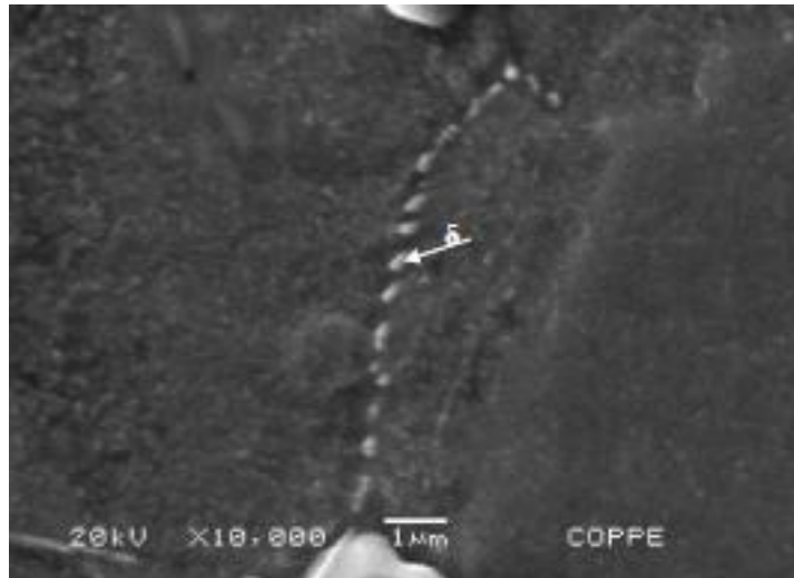
Figura 5 – Micrografia (MEV) da amostra Inconel 718 após envelhecimento a 800°C por 6 horas, mostrando a precipitação da fase delta no contorno de grão. [3]
