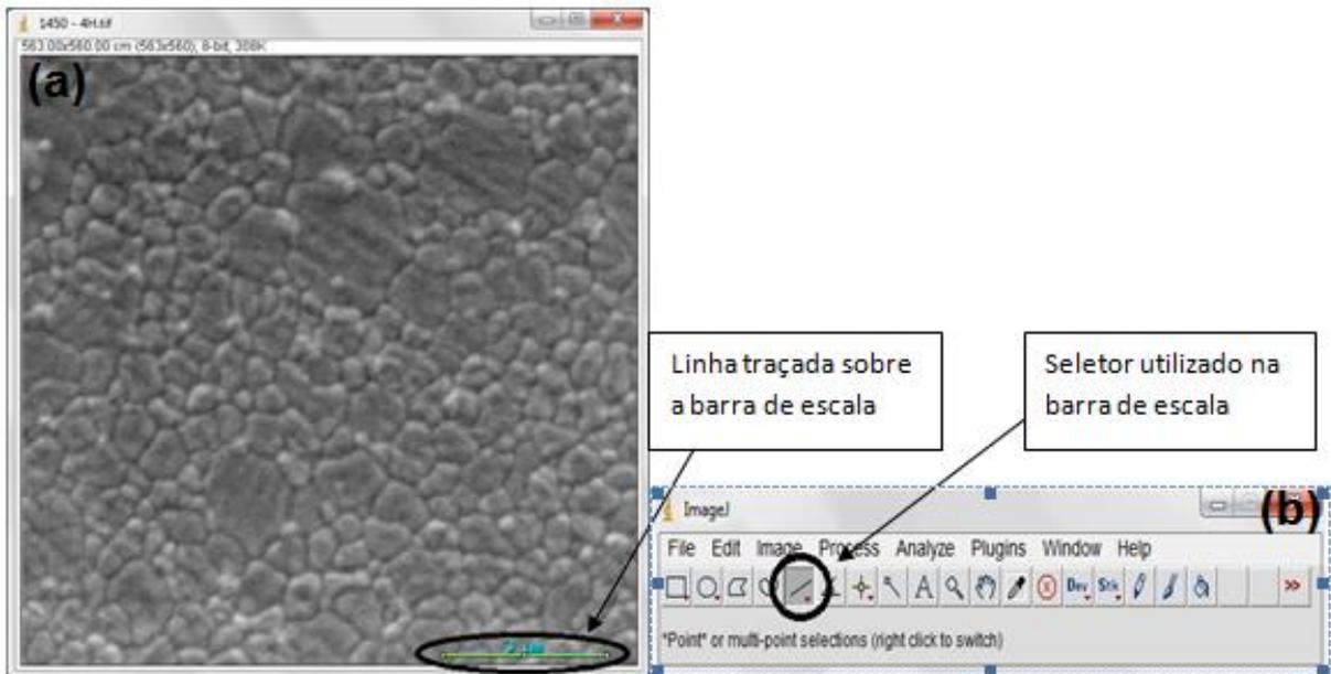
Figura 12 - (a) imagem da amostra com barra de escala selecionada (b) seletor utilizado na barra de escala.
