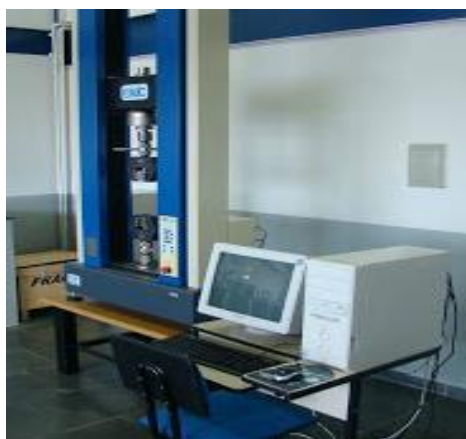
Figura 21 – Máquina Universal EMIC utilizada nos ensaios
